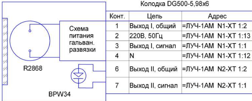
Рис.1. Фотодатчик ФД-05 ГМ. Схема электрическая принципиальная.
